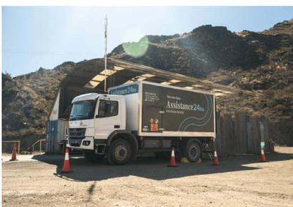
Mercedes-Benz Camiones y Buses fortalece su posición como aliada del sector minero. La compañía implementó un Taller Móvil in situ, montado sobre un camión Atego 1726 4x4 adaptado a las exigencias de la actividad minera en Catamarca. Diseñado para operar dentro del área de trabajo, permite realizar mantenimiento y reparaciones sin necesidad de trasladar los vehículos a talleres urbanos.
